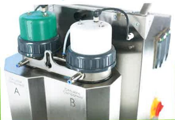
Réservoir de résine Spray-Liner® pour composants A et B
