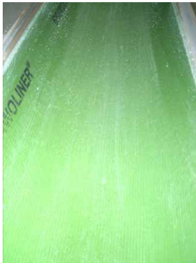
III. 16 : échantillon B1003-1.2 après le test d'abrasion de 200 000 cycles
