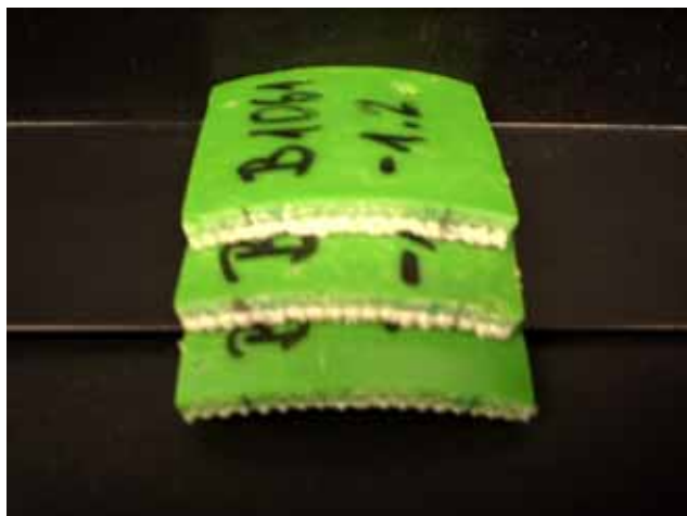
III. 13 : présentation des échantillons B1061-1.1 à -1.3 (acide sulfurique) après le séchage
