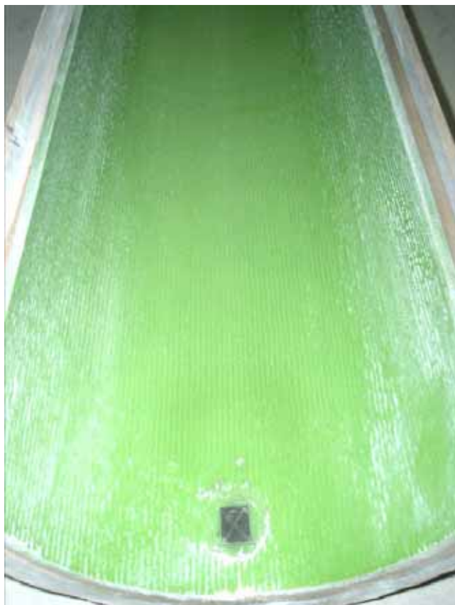
III. 15 : échantillon B1003-1.1 après le test d'abrasion de 200 000 cycles
