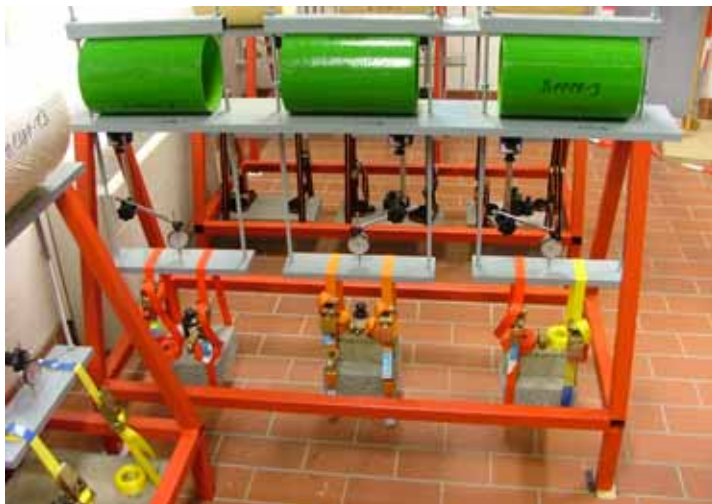
III. 17 : banc d'épreuve pour l'essai longue durée à la pression maximale à l'IKT
